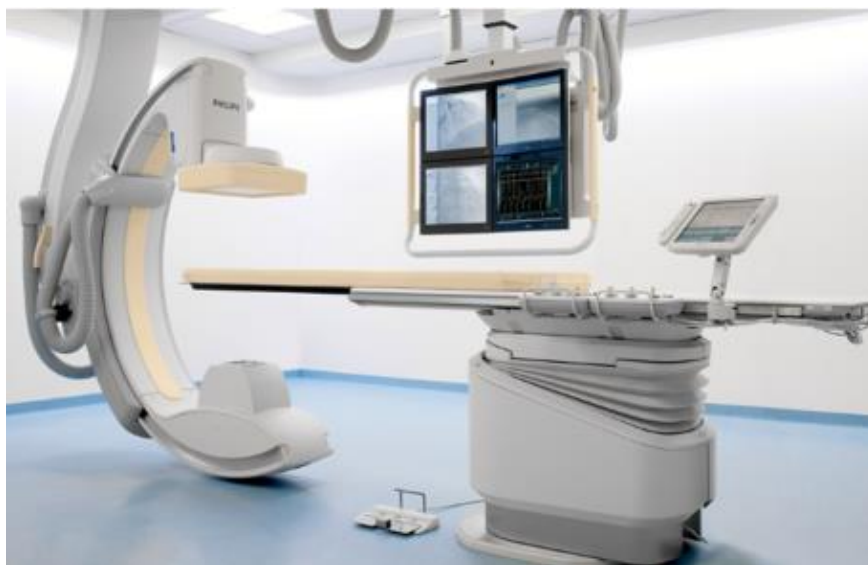
图 9-1 血管造影机 DSA 典型设备图
