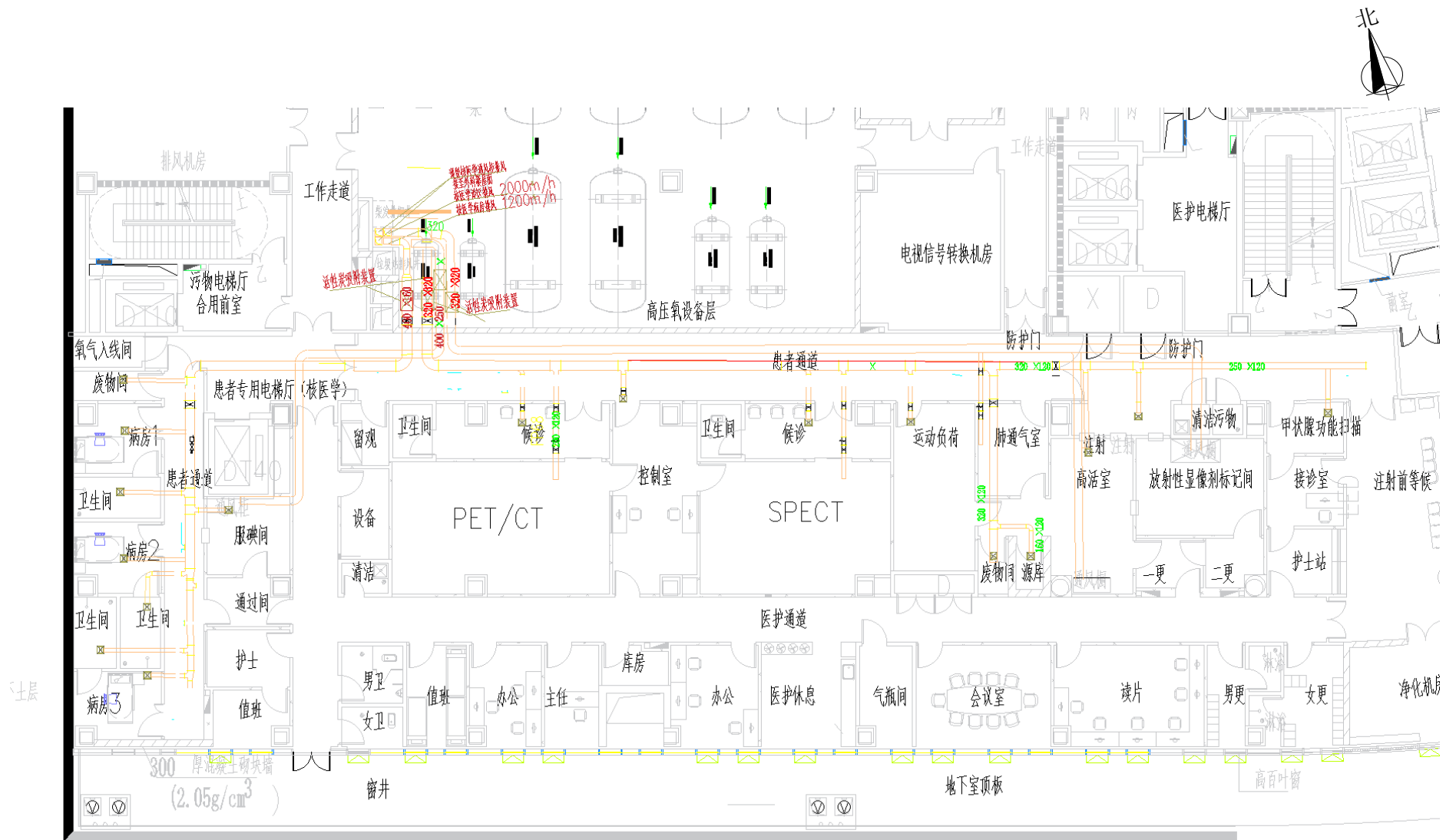
图 10-2 拟建核医学科放射性废气通风路由示意图
